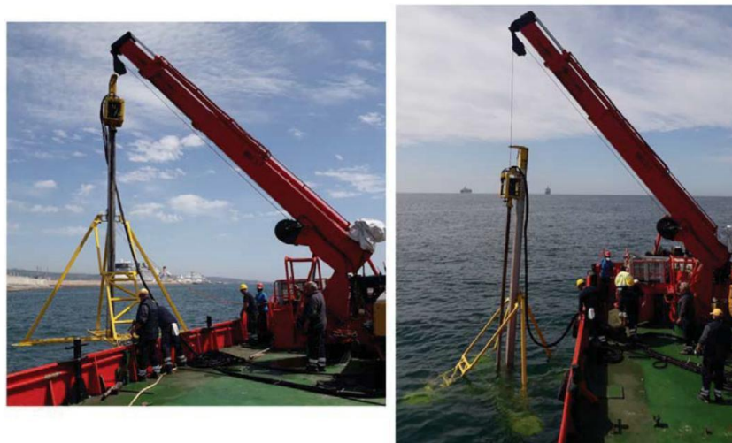
Figura 22: Sondaggi vibrocore: apparecchiatura utilizzata
